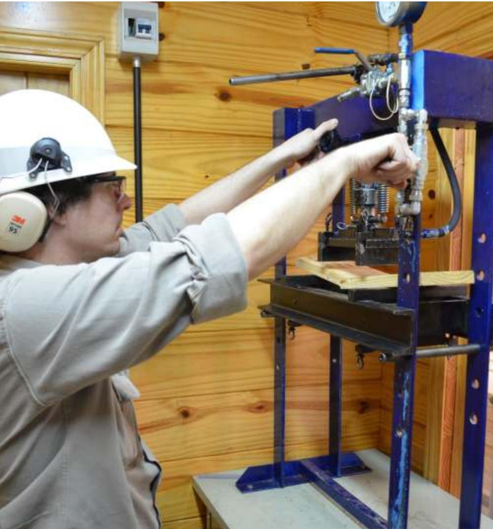
Consiste en comprobar la resistencia de unión de encolado en el finger Joint de las láminas que posteriormente conformaran la viga. Durante el proceso productivo se retira, 3 muestras por lote, y luego de 48 hs, se procede a los ensayos.
