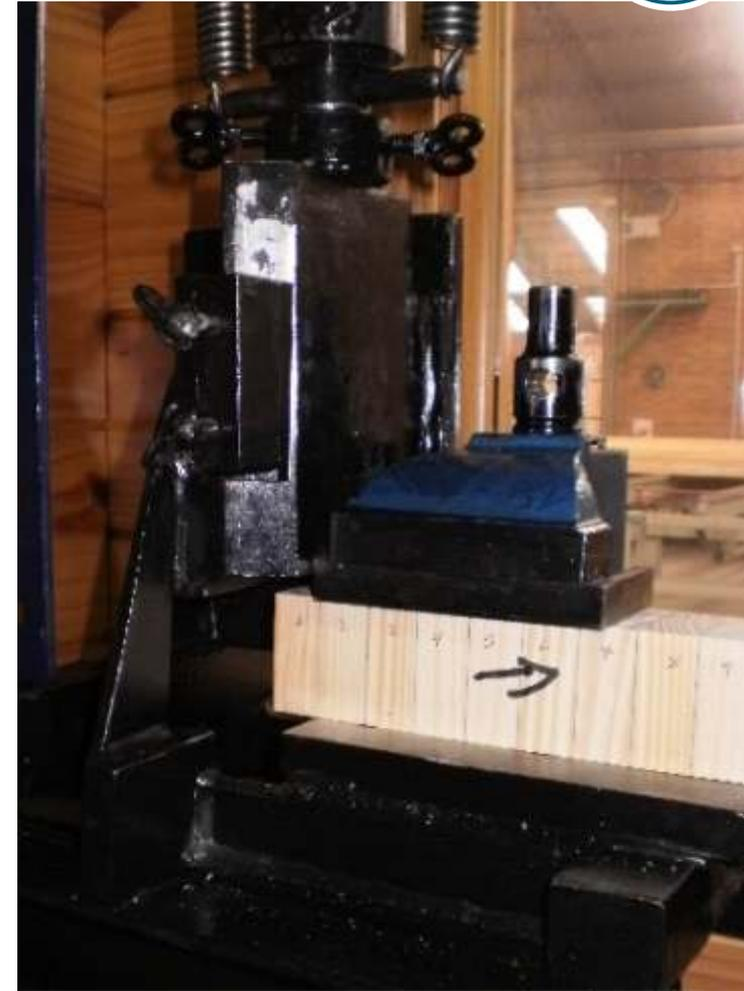
Probeta para ensayo de cizallamiento y prensa
