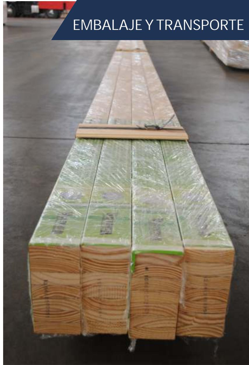
Utilizar equipos adecuados para la carga y prevea que los camiones tengan lonas para cubrir el material durante el transporte desde el depósito del vendedor hasta la obra. utilizarlo.
